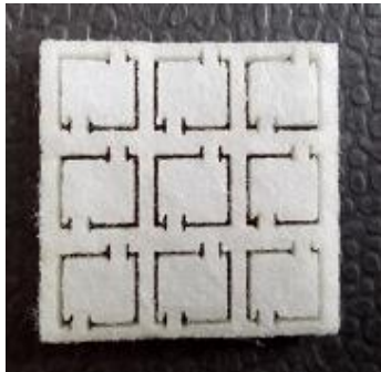
Double-Leg TEG: einfache Beinchenstruktur
