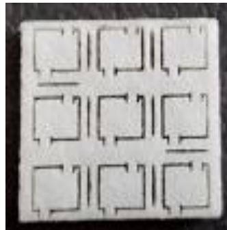
Uni-Leg TEG: Beinchenstruktur mit Schlitz
