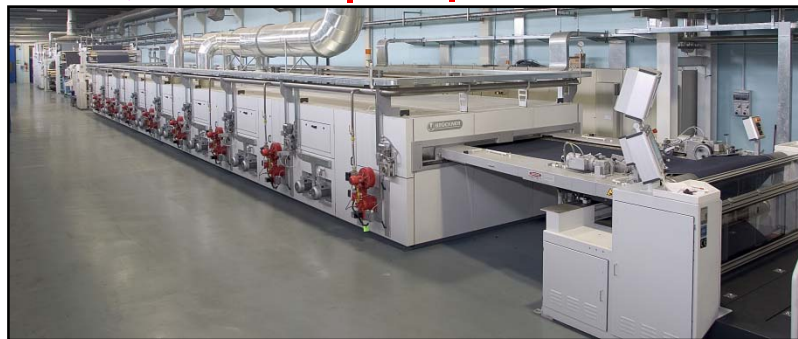
Spannrahmen mit indirekter Gasheizung
