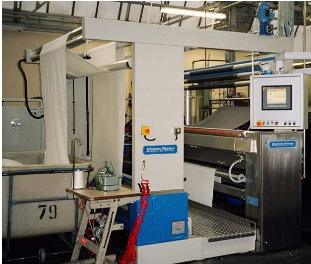
Warenzuführung, Antriebe und Touchscreen Kontrollsystem
